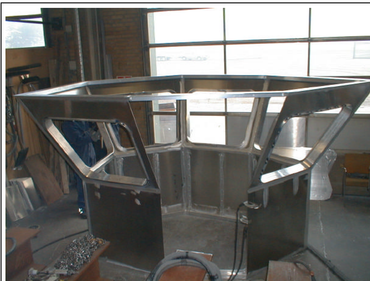
Figur 2.170 Færdigt Styrehus C1, vinduesrammer endnu ikke svejst på indvendige side.
