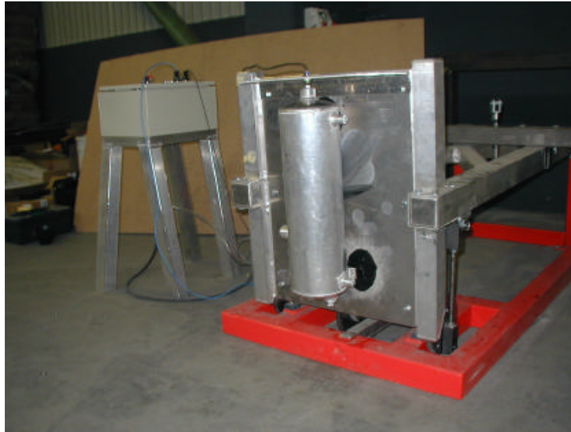
Figur 4.37 Mekanisk prøvning af prototype til dræntank.
