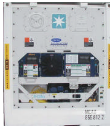
Figur 4.30 Stakkede Kølecontainere (TV) og Køleagregat monteret i Kølecontainer (TH).
