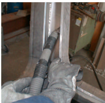
Figur 2.167 Isætning af vinduesrammer i styrehus C1.
