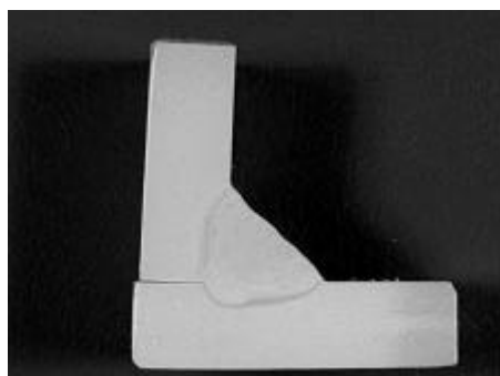
Figur 3.65 Typisk indtrængning med 100% argon.
