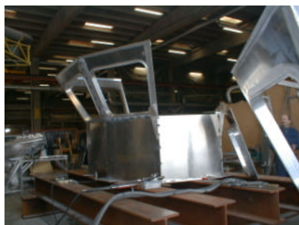
Figur 2.172 Styrehus paneler (C2) ophæftet. Bemærk hjelpebeslagene, så den rigtige vinkel fås.
