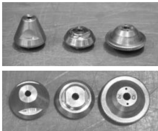
Figur 3.32 3 slags plasmasvejsedyser. Fra venstre: a) Enkelthulsdyse til svejsning i indvendige hjørner. b) Enkelthulsdyse til svejsning af stumpsømme. c) Flerhulsdyse til svejsning af stumpsømme.
