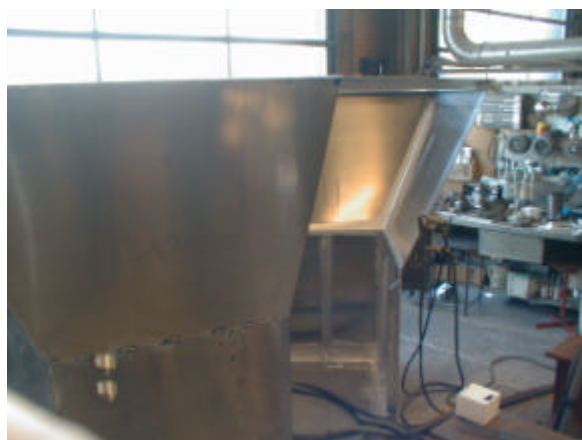
Figur 2.166 Opstillede og hæftede delpaneler, model C1.
