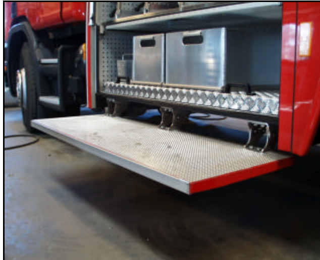
Figur 4.6 Billede af komposit skabsdel med pålimet hængselramme udviklet af Ringe Karosserifabrik ApS.
