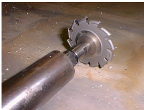
Figur 3.129 Roterende håndfræser. Denne type bliver ikke tilstoppet af aluminiumspåner.
