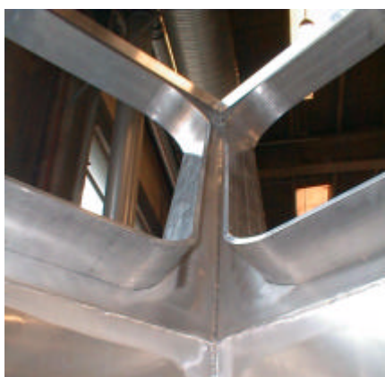
Figur 2.167 Isætning af vinduesrammer i styrehus C1.
