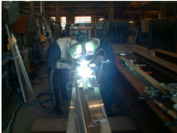
Figur 2.150 Tosidet svejsning af girder.
