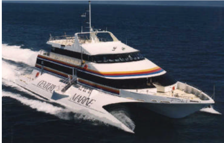
Figur 4.1 Billede af katamaranfærge fra Century Marine; skrogets sideklædning er monteret med dobbeltklæbende VHB tape.
