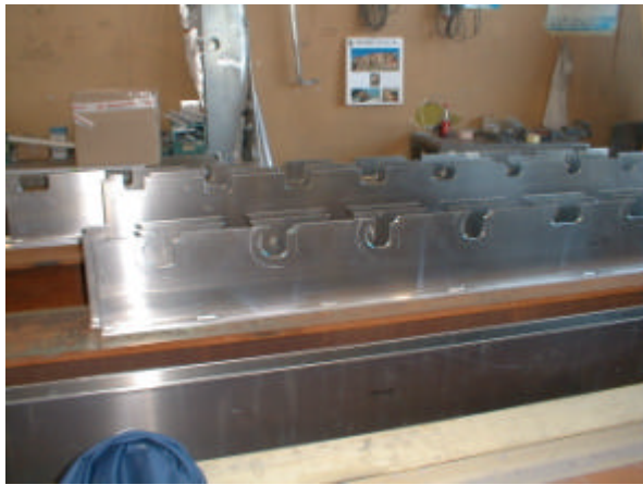
Figur 2.148 Udsavede cut-outs i girder.
