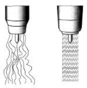
Figur 3.73 Princip ved gaslinse.
