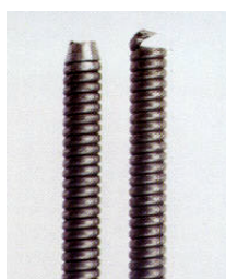
Figur 3.61 Korrekt og ukorrekt tilpasset snudespiral.
