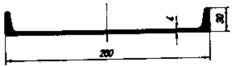
ALN 0701 Vekt: 3.925 kg/m Rekkestøtte
