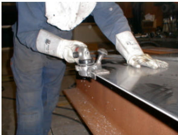
Figur 2.144 Fugeforberedelse. Råpladerne gøres klar til samling ved fræsning af V-fuge på 45° med 2 mm rodnæse. Et panel samles af 3 plader.
