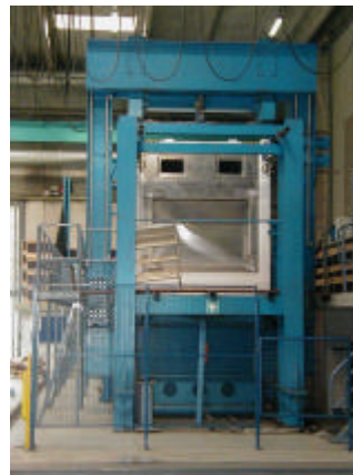
Figur 4.31 Principskitse af "Racking" test (TV) og Billede af kølecontainer monteret i testrig (TH).
