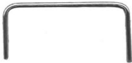
Figur 3.17 ”Vridetest” af svejsetråd: Enderne bukkes 90°, og tråden vrides 360° 5-6 gange.
